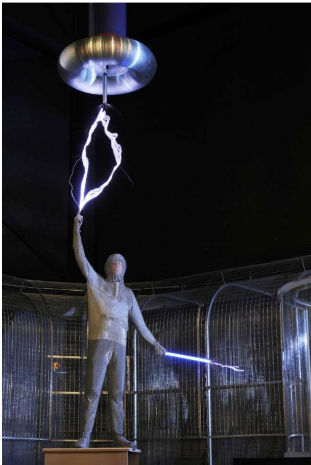
Mit der Tesla-Spule können sehr hohe Wechselspannungen erzeugt werden. Dabei wechselt die Polarität dieser Spannung bis zu 140'000 mal in der Sekunde. Die hohen Spannungen ionisieren die Luft und erlauben sehr lange Funkenentladungen. Bei der Tesla-Spule im Technorama beträgt die Spannung gut 1,2 Millionen Volt und die „Blitz“-Länge beträgt bis zu drei Metern.
